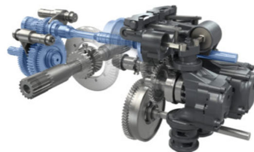
Bezpośredni napęd WOM zapewnia doskonałą wydajność. Prędkość jest zmniejszana bezpośrednio na czopie WOM.
