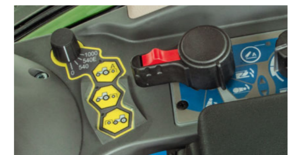
Poręczny, komfortowy przełącznik WOM z funkcją automatyczną w podłokietniku.
