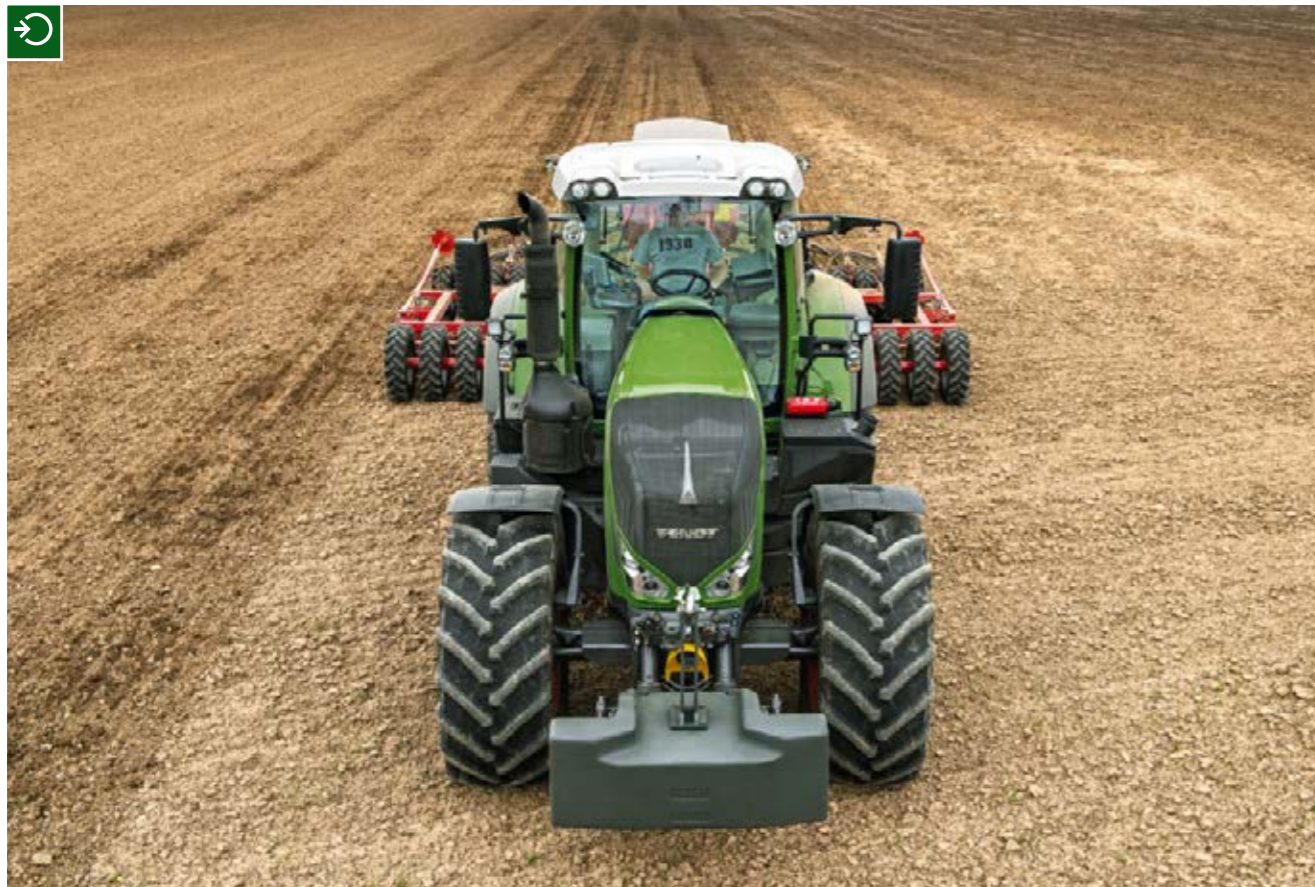
Ciągnik Fendt 800 Vario zapewnia optymalną widoczność. Maska silnika jest możliwie najwęższa, dzięki czemu operator ma doskonałą widoczność na wnęki, koła i narzędzia zamontowane z przodu.
