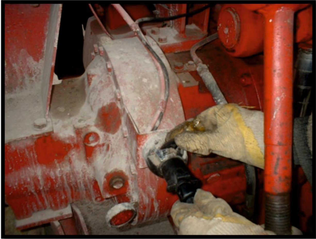
Podłącz siedmiopinowe złącze elektryczne przyczepy
